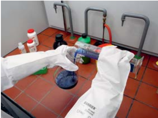
Bild 13: Bei Arbeiten mit hautgefährdenden und hautresorbierbaren Arbeitsstoffen sind ausgewählte chemikalienbeständige Schutzhandschuhe einzusetzen.
